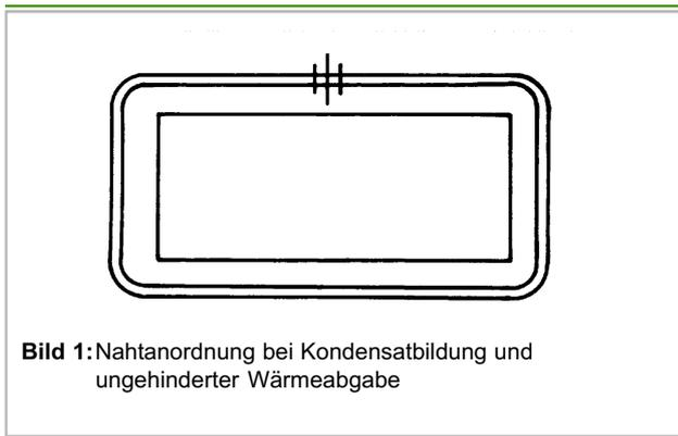
**Bild 1:** Nahtanordnung bei Kondensatanfall und ungehinderter Wärmeabgabe
